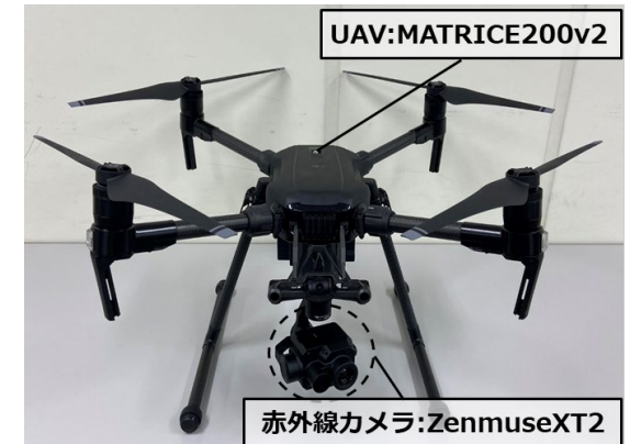
下図：システム構築で用いたドローン及び赤外線カメラ
